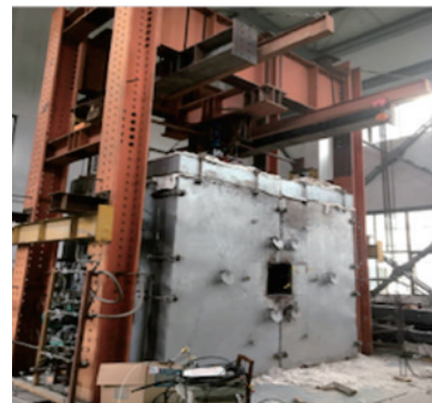
图6 火灾试验炉 Fig.6 Fire test furnace
